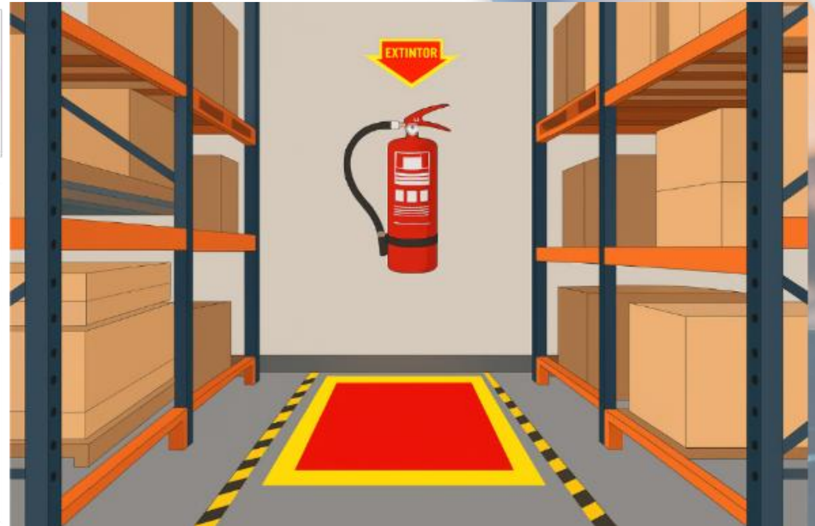
Imagen de referencia para demarcación en piso - Extintores portátiles
