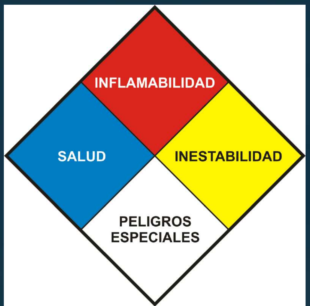
NFPA 704 Alcance: Emergencias No se adopto en Colombia
