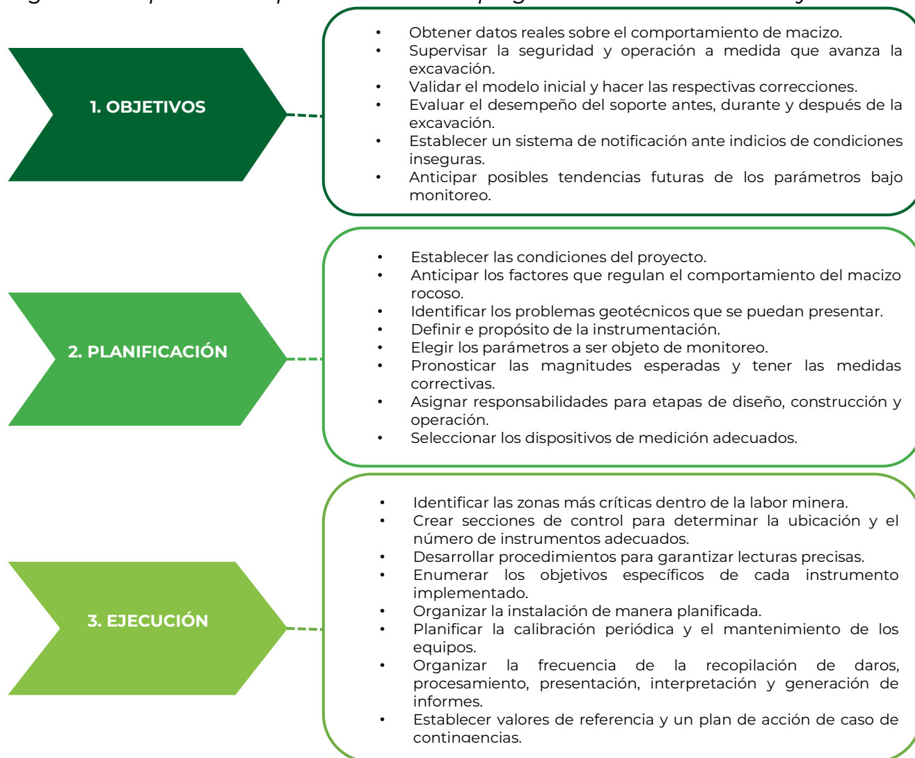
Figura 69. Esquema de la planificación de un programa de instrumentación y monitoreo
