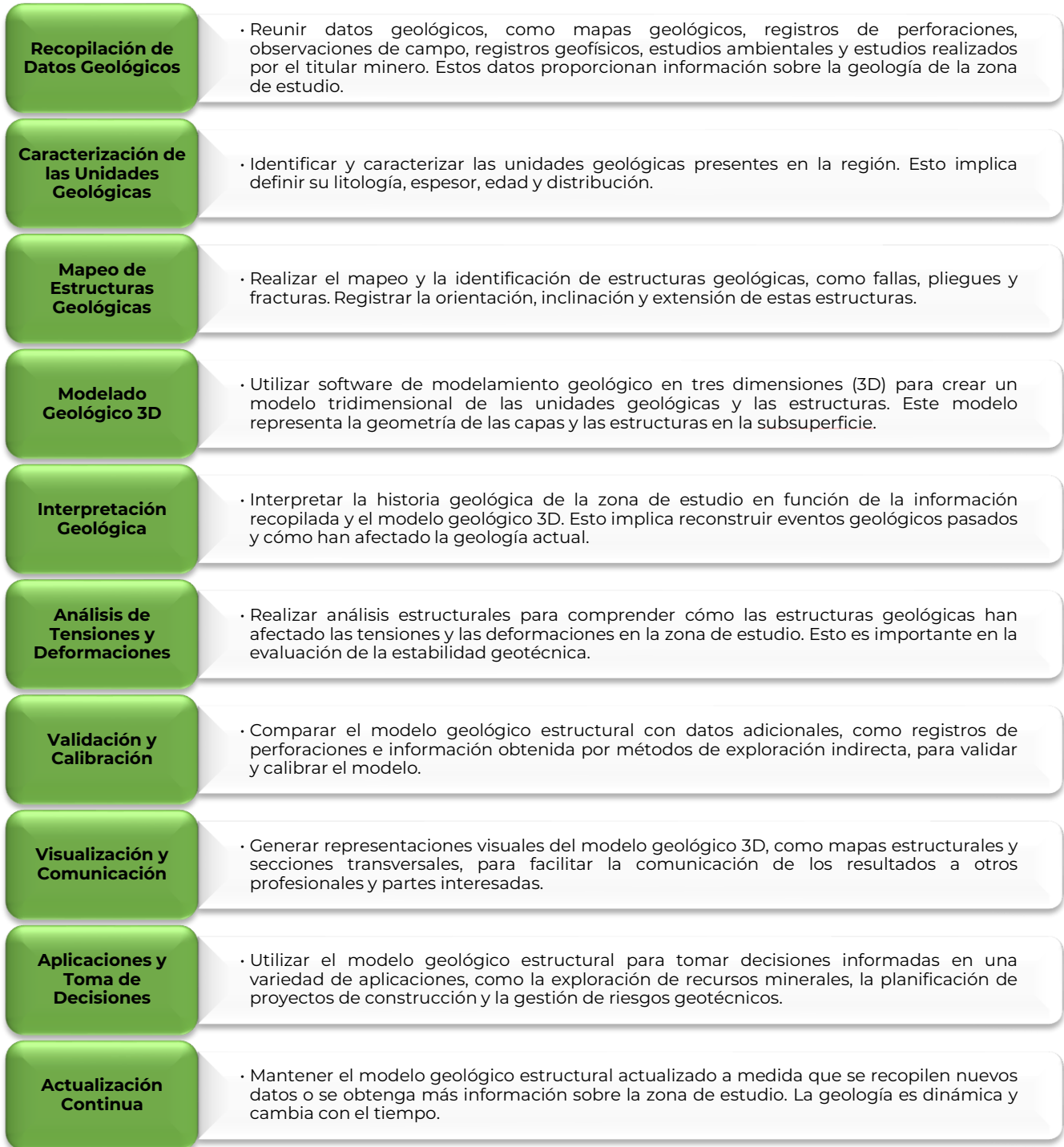
Figura 22. Pasos para realizar el modelamiento estructural
