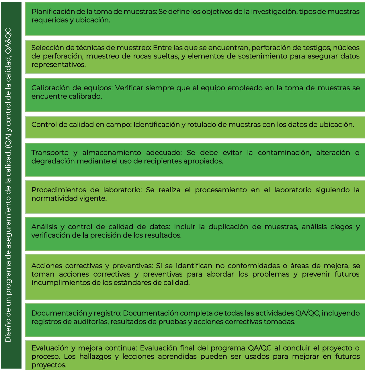
Figura 81. Diseño de un programa de aseguramiento y control de la calidad (QA/QC)
