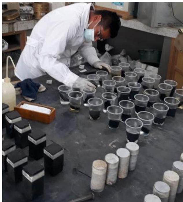
Figura 30. Determinación de propiedades físicas de las rocas
