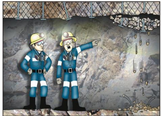
Falla de elementos de soporte. – modificado Ramírez (2004)
