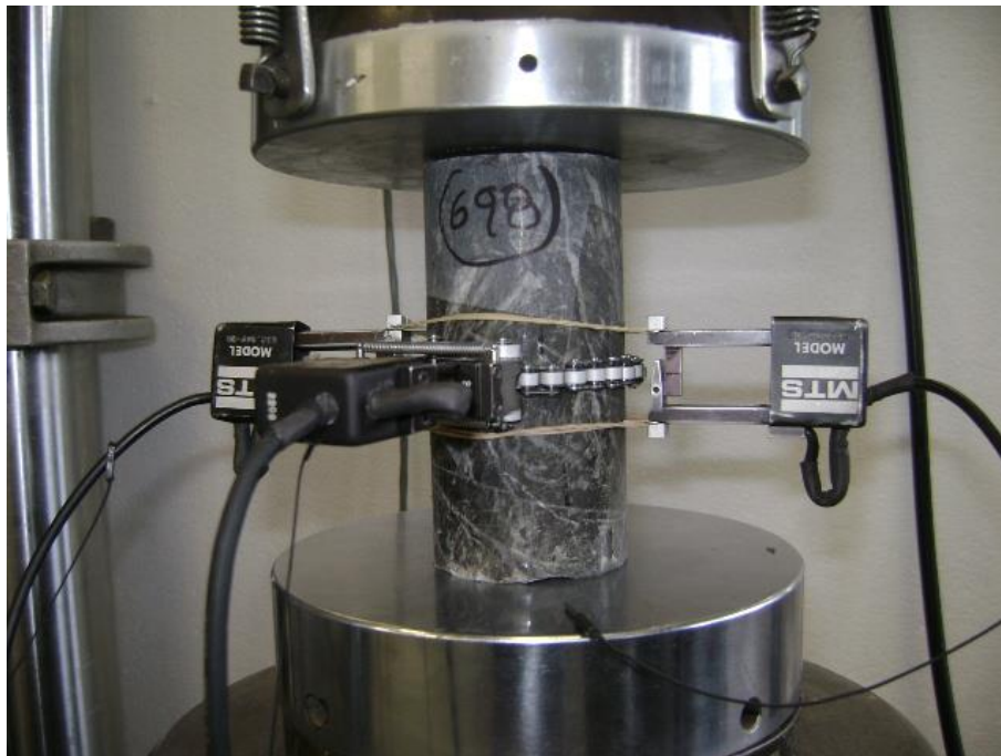
Figura 26. Ensayo a compresión simple en rocas.
