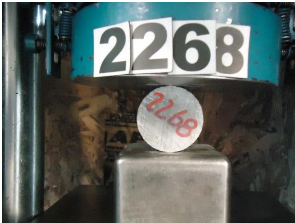
Figura 27. Montaje para el ensayo de tracción brasileño
