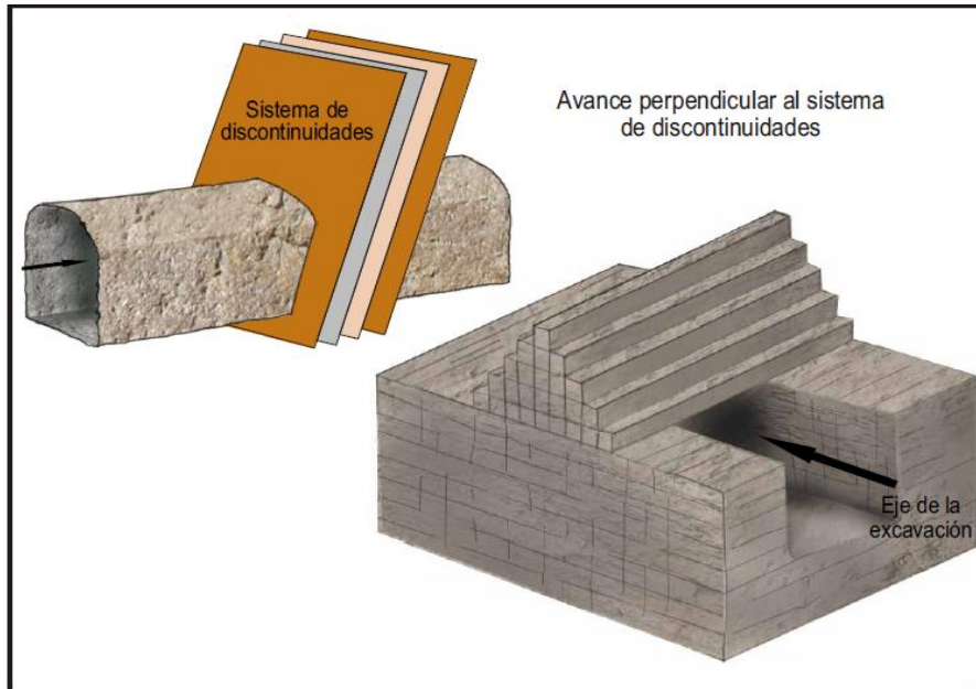
Figura 66. Condiciones de avance muy favorables para la estabilidad.
