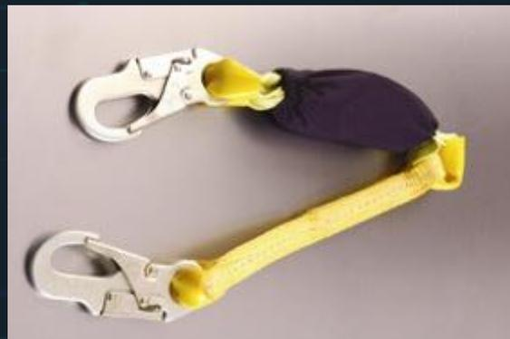
Longitud máxima 1,80 m y al activarse por efecto de la caída, permiten una elongación máxima de 1,07 m. amortiguando los efectos de la caída. Tienen la capacidad de reducir las fuerzas de impacto al cuerpo del trabajador, a máximo la MFD (máxima fuerza de detención) equivalente a 1800 libras.
