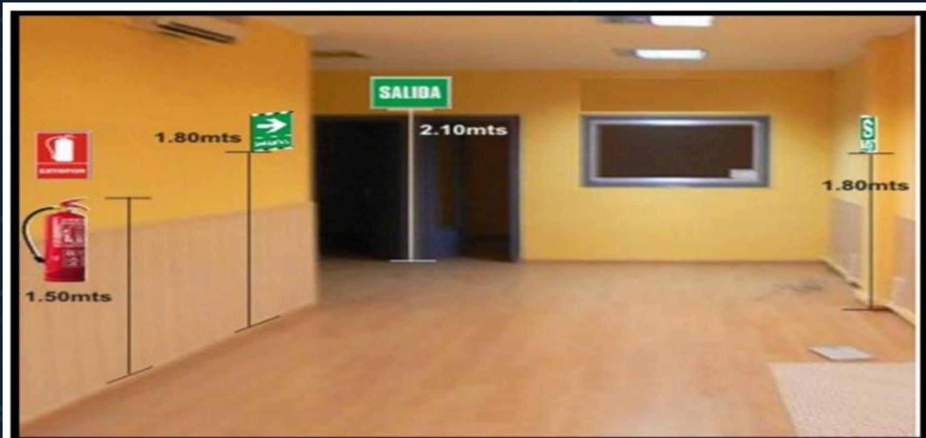
La señal del extintor se instalará a una altura de 1.80 metros y el equipo se colocará a **1.50 metros** de altura correspondiente.
