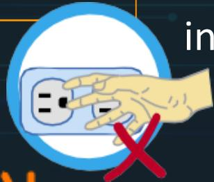
Se produce cuando la persona toma contacto con elementos que accidentalmente están con tensión por algún defecto en su aislación.
