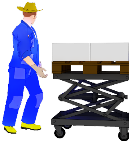
Gráfico 10. Mesa de tijera ajustable para llenado de estibas y cajas. (ErgoMotion-Lab)
