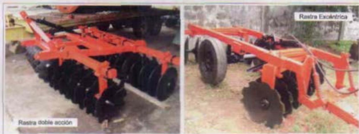
Figura 38. Clasificación de acuerdo con la disposición de los discos (fotos del autor).
