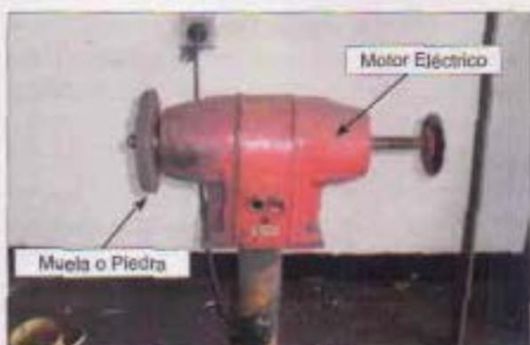
Figura 88. Partes del esmeril (foto del autor).
