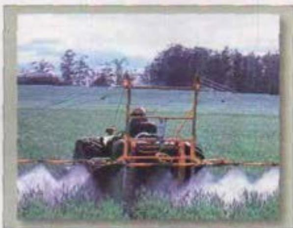
Figura 59. Altura de la barra de aspersión y forma de cobertura (fuente: JACTO).
