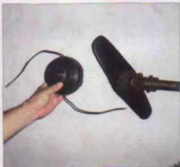
Figura 79. Cuchillas y yoyo guadaña de motor (foto del autor).
