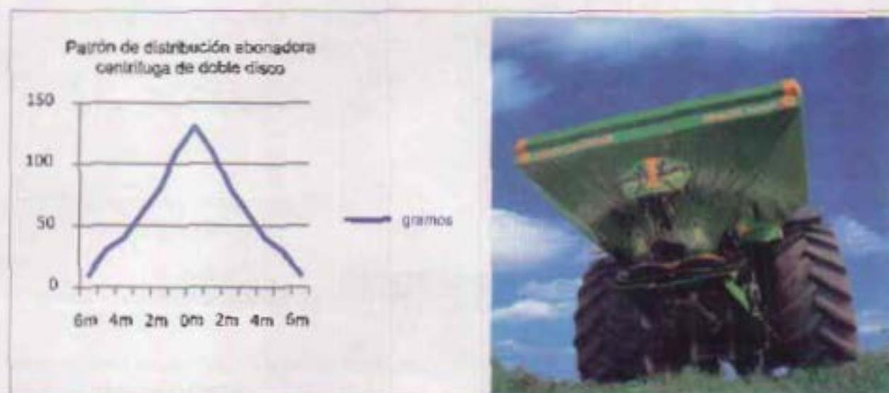
Figura 48. Patrón de distribución de la abonadora centrífuga de doble disco (fuente: AMAZONÉ).
