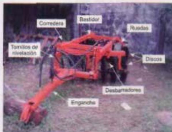
Figura 37. Partes de la rastra de discos (foto del autor).
