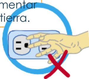
Se produce cuando la persona toma contacto con elementos que accidentalmente están con tensión por algún defecto en su aislación.
