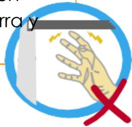
Se produce cuando la persona toma contacto con las partes activas de la instalación.
