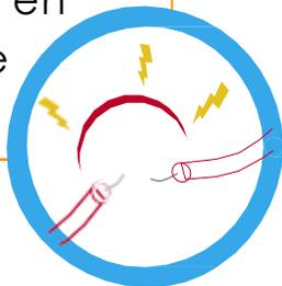
Descarga continua entre dos conductores relacionados con una condición peligrosa asociada con la liberación de energía causada por un arco eléctrico.
