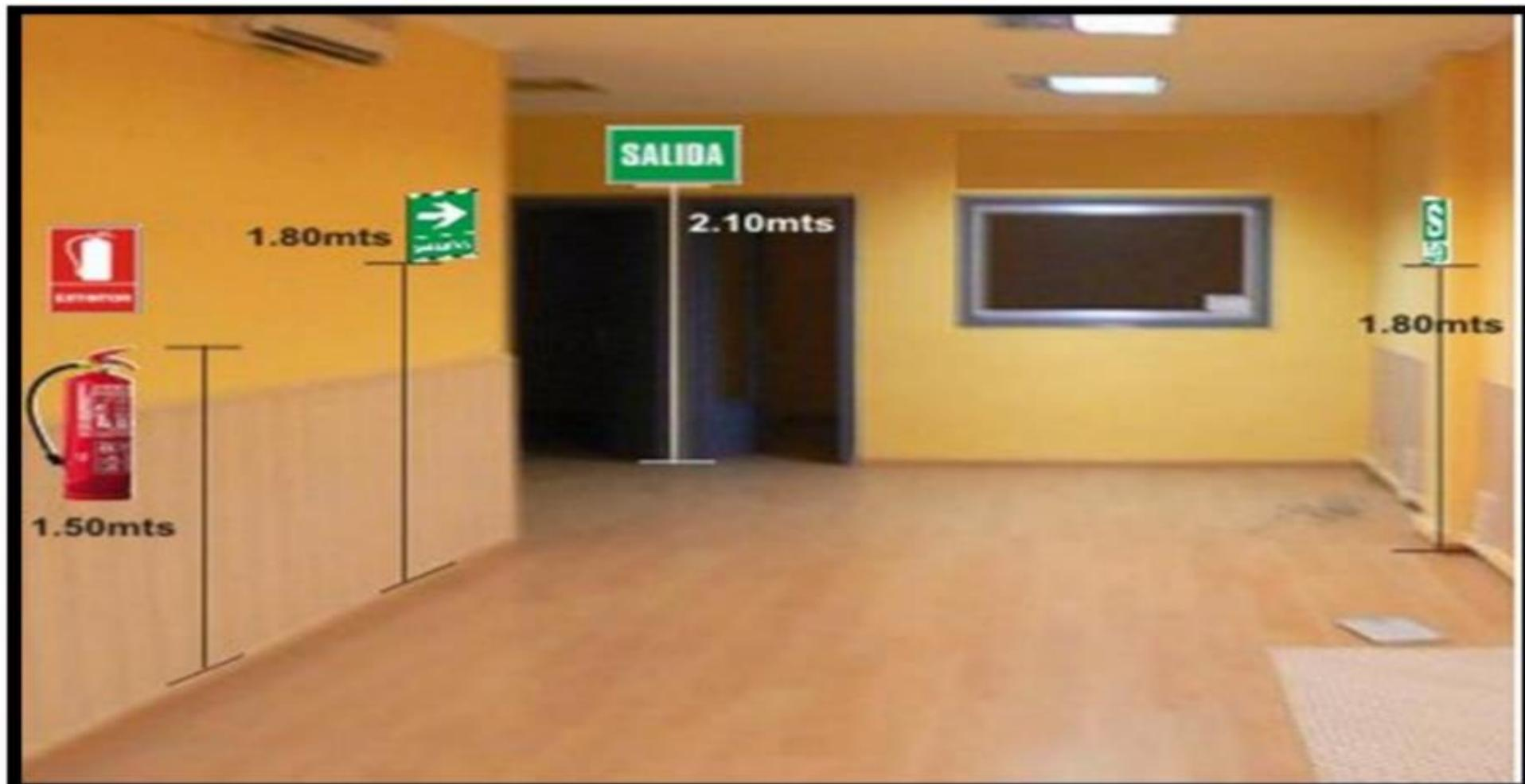
La señal del extintor se instalará a una altura de 1.80 metros y el equipo se colocará a **1.50 metros** de altura correspondiente.
