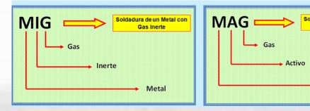
Creación de atmosfera inerte (Desplazamiento de oxígeno por otro gas) o atmosfera activa
