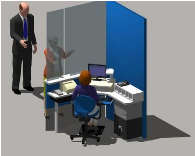
Gráfica 3. Distribución recomendada para el diseño de estaciones de trabajo con atención a público o en áreas aisladas.
