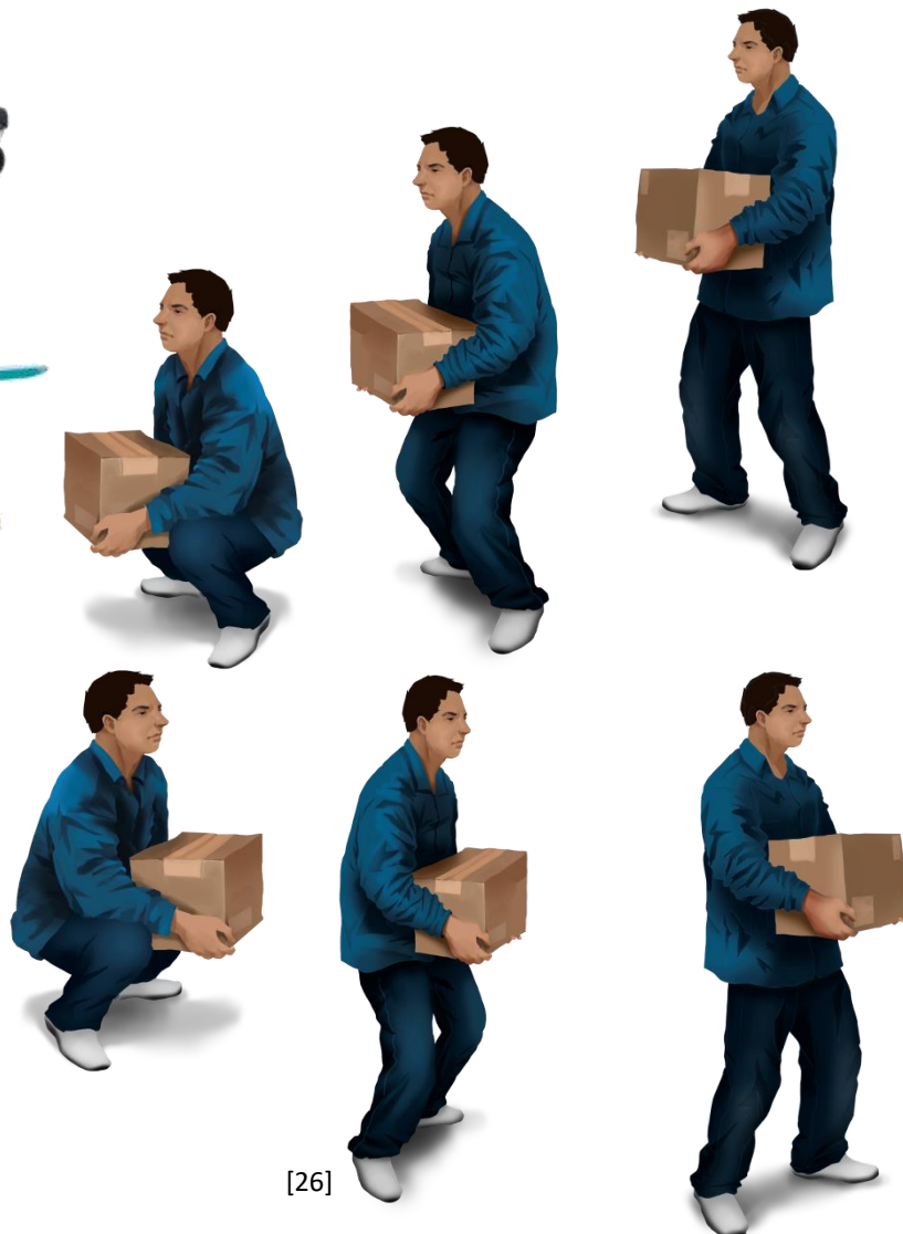
Gráfica 36. Técnica recomendada para el levantamiento de cargas hasta 17,5 kg. Para pesos mayores se deben utilizar ayudas mecánicas o realizar el trabajo en equipo.
