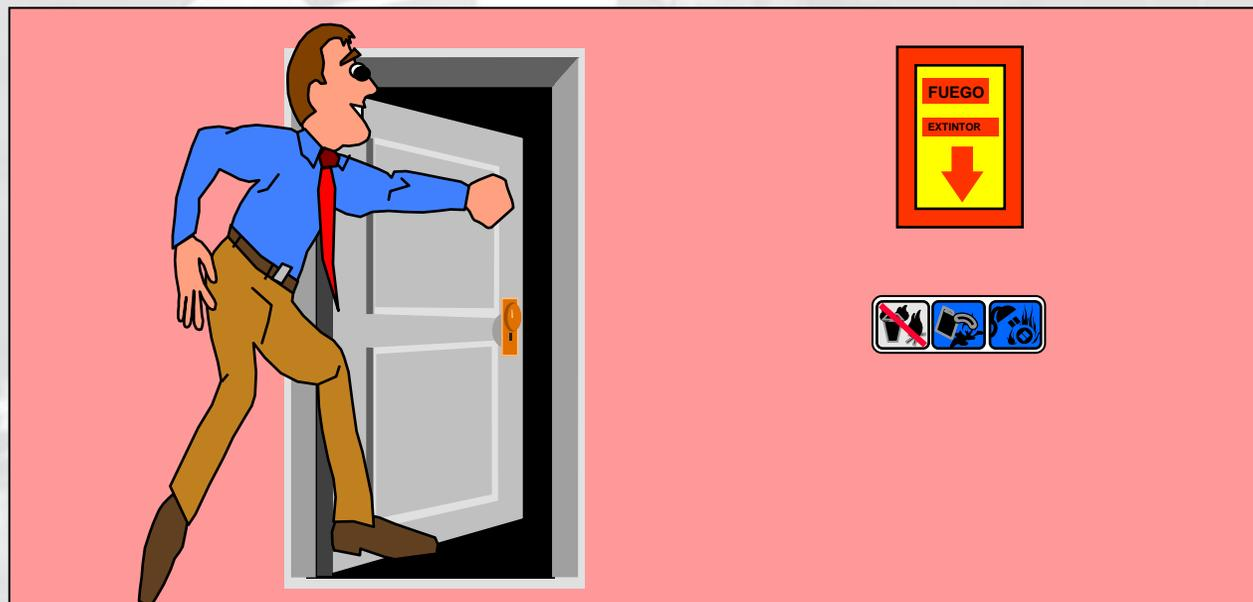
**Colocación del lado exterior de las puertas de acceso a una altura máxima de 1.50 mts del piso a la manija de transporte**
