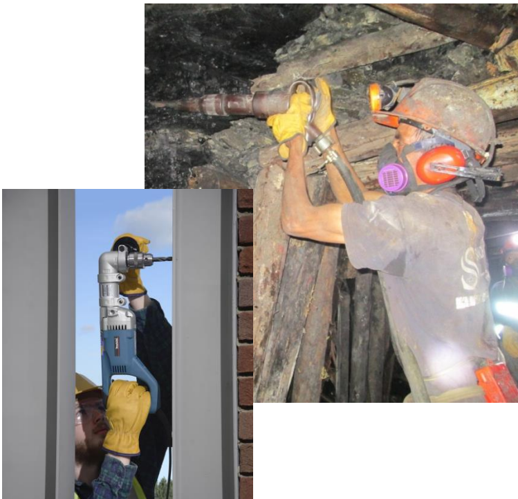
Gráfica 9. Adaptadores de ángulo y posicionadores para las herramientas manuales. Fuente: Canadian Centre for Occupational Health & Safety, 2018
