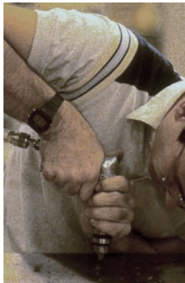
Gráfica 25a. Un buen diseño de herramienta respeta los rangos normales de movimiento y los ángulos de uso biomecánicamente ajustados.
