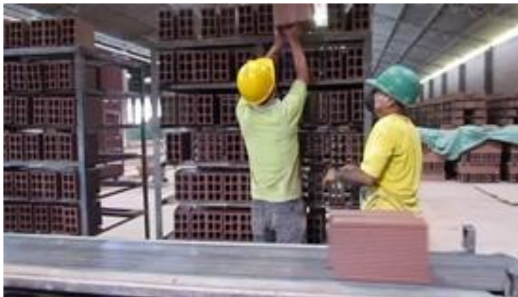
Gráfica 32. Diseño adecuado para estructuras de almacenamiento. Se observa que la fila inferior permite el almacenamiento de cargas pesadas y voluminosas sobre estibas con el fin de movilizarlas con carros hidráulicos o con montacargas.
