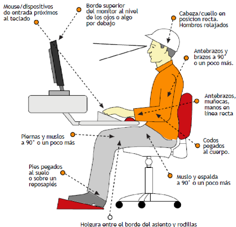
Gráfica 3. Las dimensiones de los componentes de las situaciones de trabajo deben adaptarse a los trabajadores.
