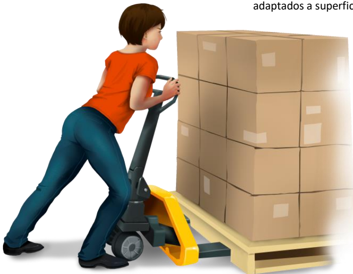
Gráfica 21. Para el desplazamiento empujando pesos y cargas de gran volumen, se deben utilizar gatos hidráulicos o neumáticos con control de frenado, adaptados a superficies continuas y planas.
