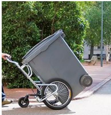
Gráfica 33. Dispositivo para mover sin esfuerzo un contenedor lleno adoptando posturas de trabajo estandarizadas.
