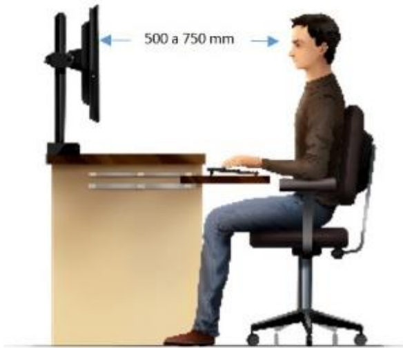
Gráfica 4. Dimensiones básicas recomendadas para estaciones de trabajo sedente.
