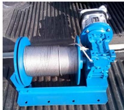
Malacate neumático con capacidad de levantamiento de una carga con una masa de 200 kg
