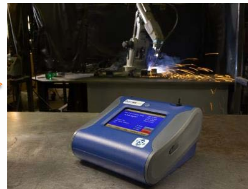
Monitor de Aerosoles DUSTTRAK DRX - contador de partículas
